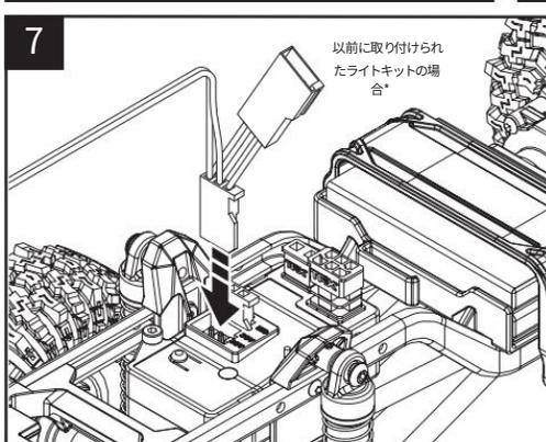
Y ハーネスを電子制御モジュール (ECM) の開いている ACC ポートに差し込みます。バッテリーを接続して ECM の電源をオンにすると、LED ライトが点灯します。
