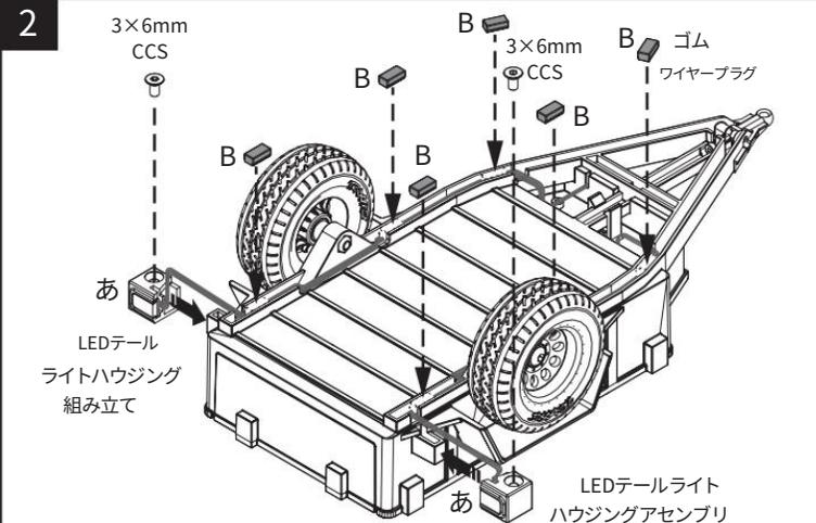
A.両方の LED テールライト ワイヤリング ハーネスをトレーラー フレームの下側のチャンネルに通します (トレーラー ライトの配線図を参照)。付属の 3x6mm CCS (2) を使用して、ハウジングアセンブリを左右のテール ライト ポストに取り付けます。
